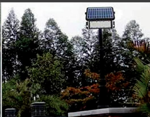
Lampade ad energia solare, sono di facile e veloce installazione senza bisogno di collegamenti alla rete di alimentazione elettrica. Il pannello solare e la batteria accumulano energia, che attiva la lampada a LED solo durante le ore notturne e al rilevamento di movimenti, grazie a dispositivi intelligenti come il sensore crepuscolare e di movimento.
